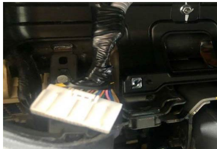
Fig. 1.4. Detalle del montaje final de la toma de señal y paso de manguera blindada por detrás del cuadro.
