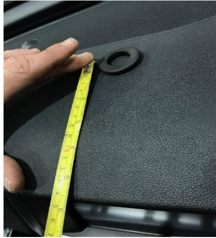
Fig. 4.4. Agujero para paso del cables al interior del salpicadero.
