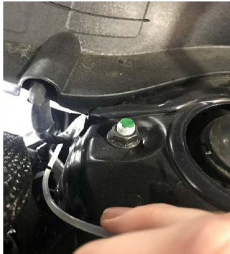
Fig. 2.2. Paso de cables de alimentación, vista compartimento motor.
