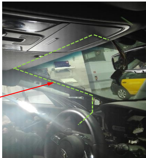
Fig. 4.9. Conexión del taxímetro de espejo con la caja adaptadora
