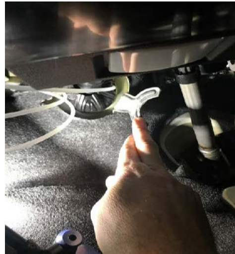
Fig. 2.3. Paso de cables de alimentación junto a la columna de dirección, vista habitáculo.
