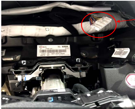
Fig. 1.1. Vista de la ubicación del conector M08 detrás del cuadro de instrumentos
