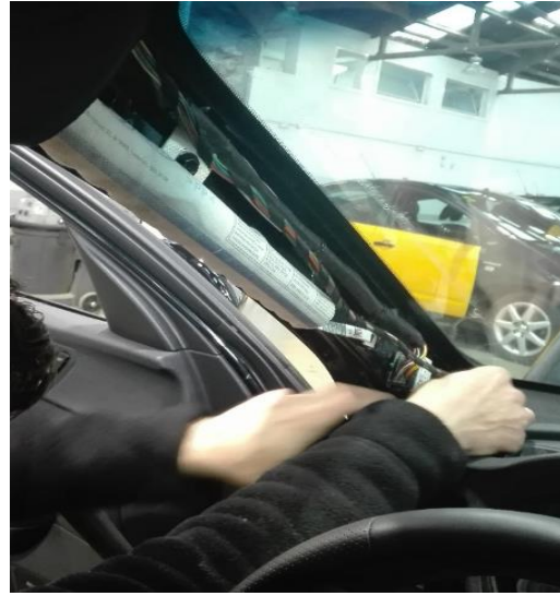
Fig. 4.7 y 4.8. Desmontaje del guarnecido de la puerta y del marco
