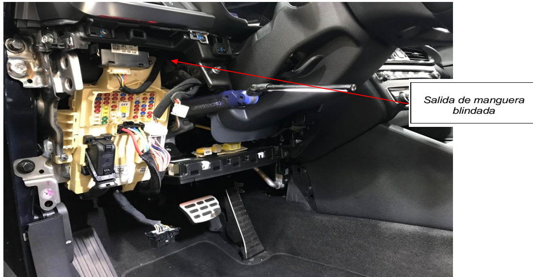
Fig. 1.6. Detalle de la terminación y paso de manguera desde el interior del cuadro.
