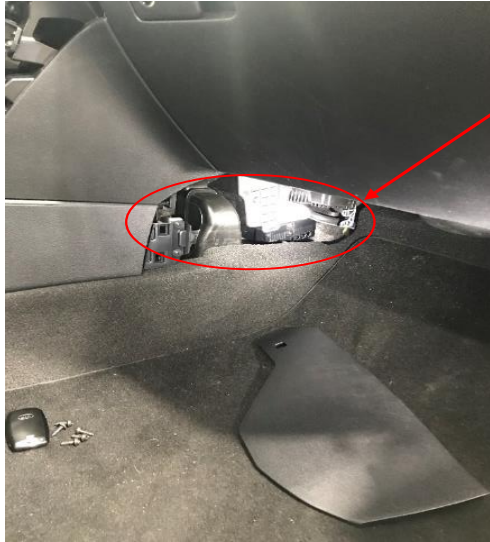
Fig. 7.2. Zona de paso de la manguera desde la caja de conexiones desde el módulo de emergencias.
