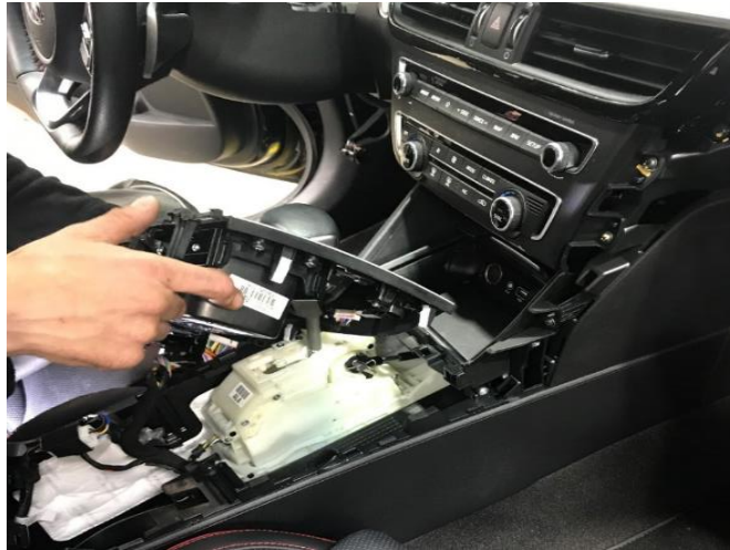
Fig. 5.2. Desmontaje de la tapa de la consola central
