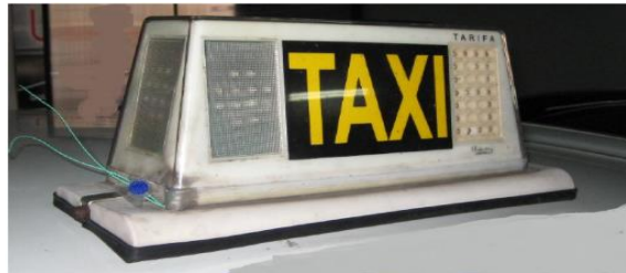
Fig. 6.3. Vista del módulo y su precinto
