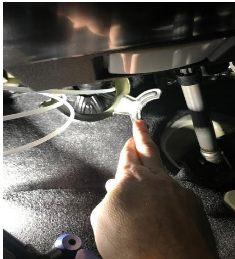
Fig. 2.3. Paso de cables de alimentación, vista habitáculo.
