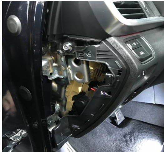
Fig. 3.2. Desmontaje de la tapa lateral del salpicadero
