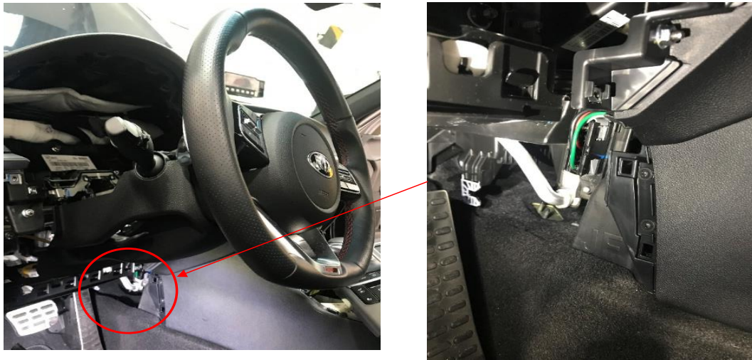
Fig. 4.5. Paso de cables a la caja de conexiones.
