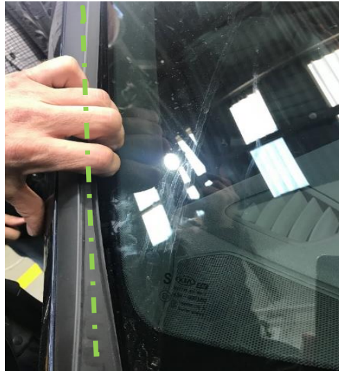
Fig. 6.5. Recorrido del cable del módulo por la moldura exterior del marco del parabrisas
