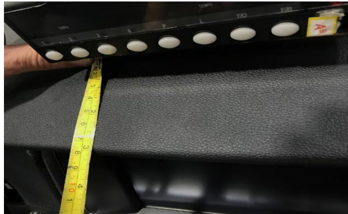
Fig. 4.3. Separación del taxímetro al borde del salpicadero.
