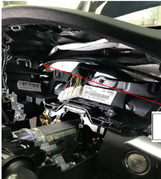
Fig. 1.5. Detalle del paso de manguera por el interior del cuadro.
