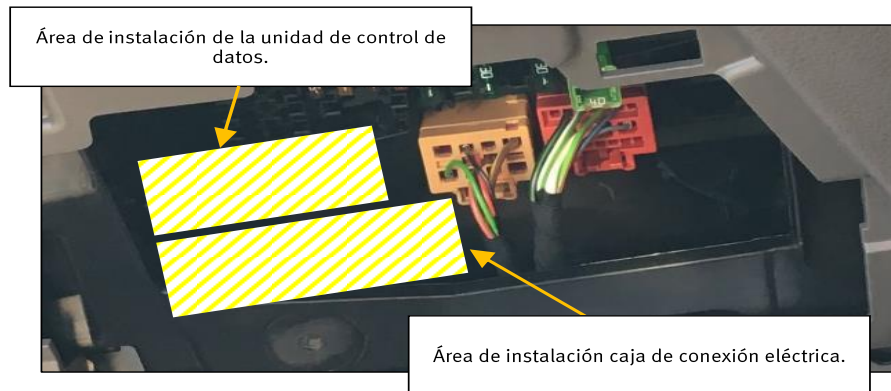
Figura 46. Área de instalación de la unidad de control de datos.
