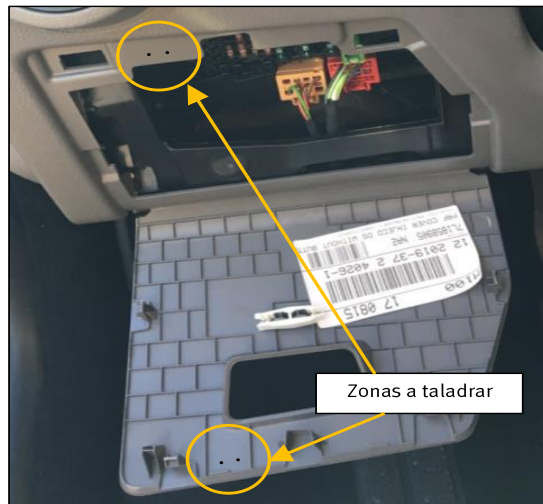
Figura 4. Zonas a taladrar en el área de la caja de fusibles.
