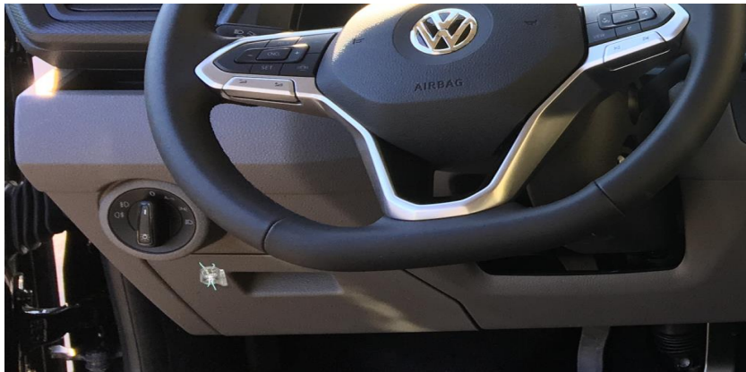
Figura 25. Precinto caja de fusible
