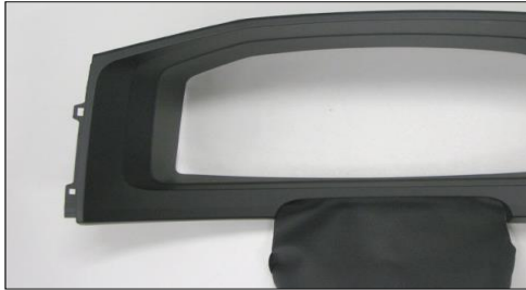
Figura 20. Cubierta cuadro de instrumentos.
