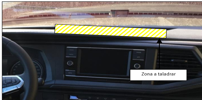
Figura 27. Zona a taladrar para el paso de mangueras.
