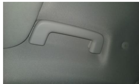
Parasol y asidero del copiloto. Fijación mediante tornillos (Idem para lado conductor)
