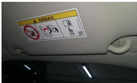
Parasol y asidero del copiloto. Fijación mediante tornillos (Idem para lado conductor)
