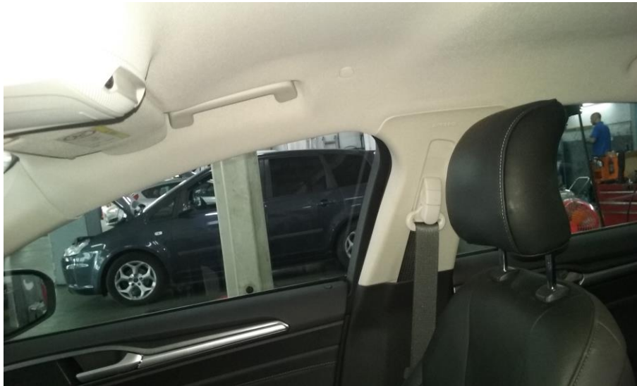
Detalle de Parasol, asidero y Pilar B del lado del copiloto. Van fijados mediante grapas y tornillos.
