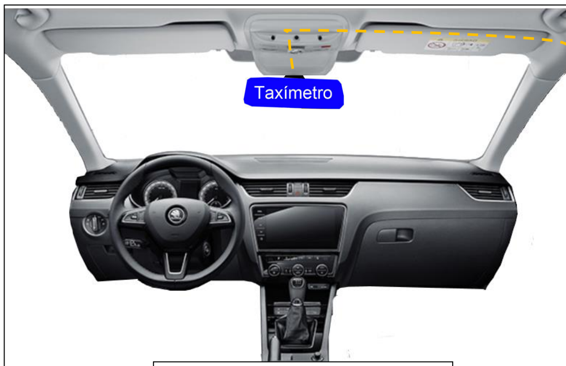
Trazado del cable del módulo tarifario
