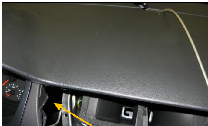
Zona paso cable impresora en el interior del tablero de instrumentos
