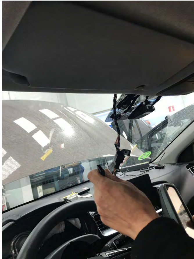
Fig. 4.4. Salida de cables para taxímetro de espejo
