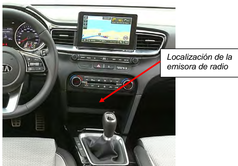
Fig. 7.2. Vista del emplazamiento previsto para la emisora de radio
