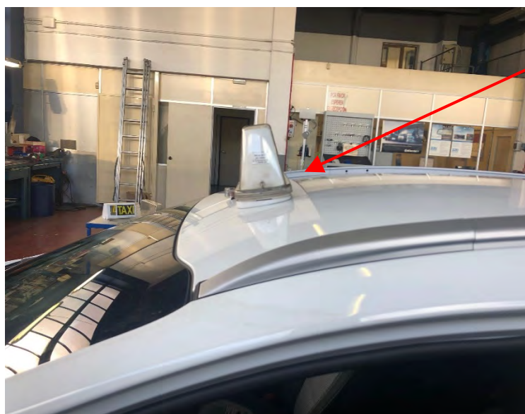
Fig. 6.1 Vista lateral del módulo atornillado
