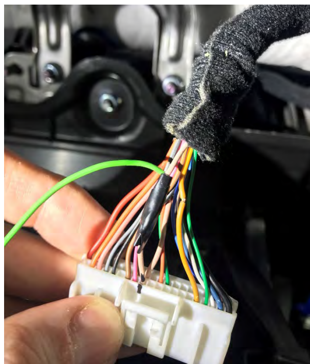
Fig. 1.4. Detalle de la conexión del cable de señal para el taxímetro con el cable del pin 12
