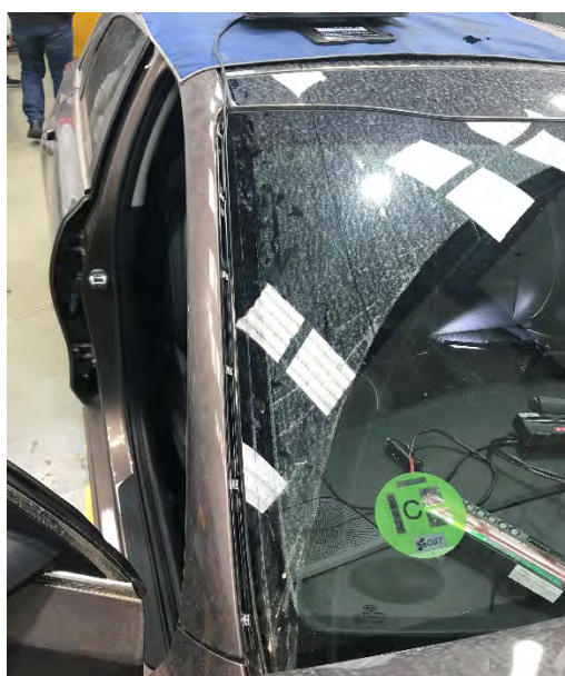
Fig. 6.5. Recorrido del cable del módulo por el exterior del marco del prabrisas
