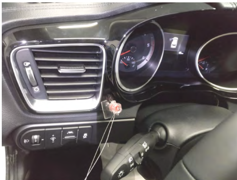
Fig. 1.7. Vista del precintado del cuadro de instrumentosl.
