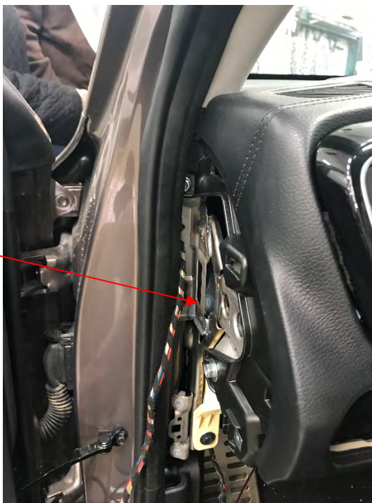
Fig. 4.2. Conexión del taxímetro con la caja adaptadora
