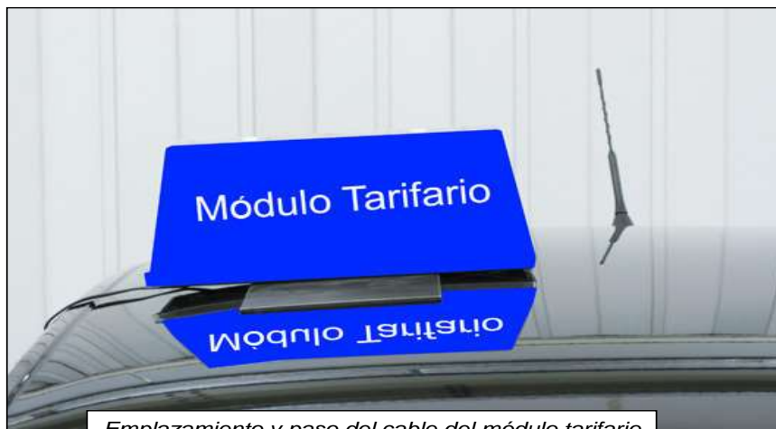
Emplazamiento y paso del cable del módulo tarifario
