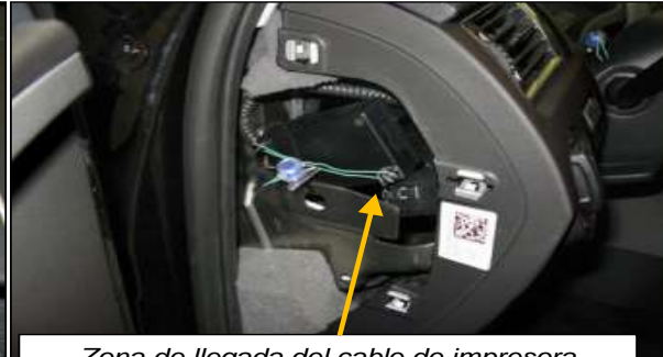
Zona de llegada del cable de impresora
