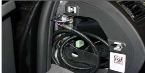
Paso de la manguera hacia la tapa lateral
