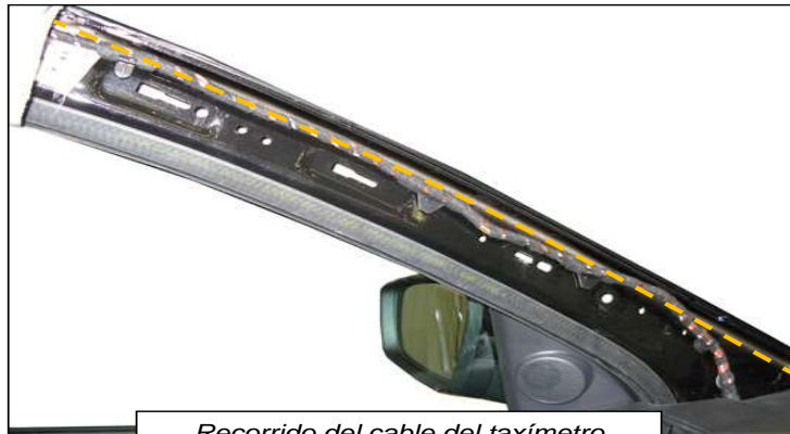
Recorrido del cable del taxímetro
