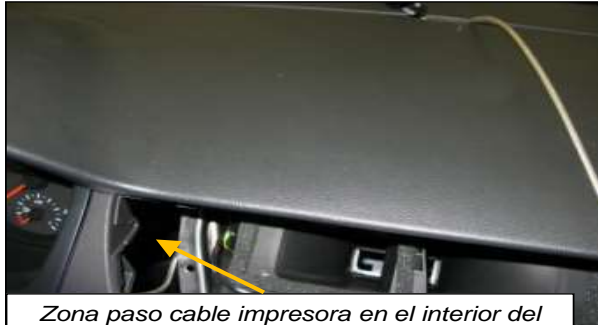
Zona de llegada del cable de impresora
