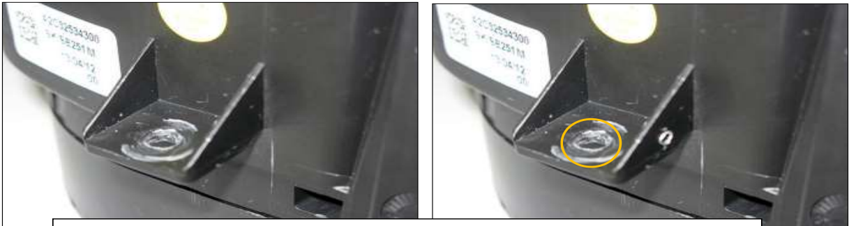
Detalle del agujero del soporte de fijación izquierdo del cuadro de instrumentos
