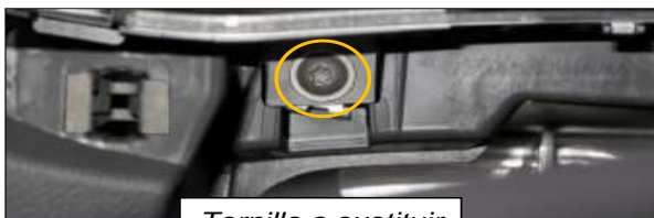
Tornillo a substituir
