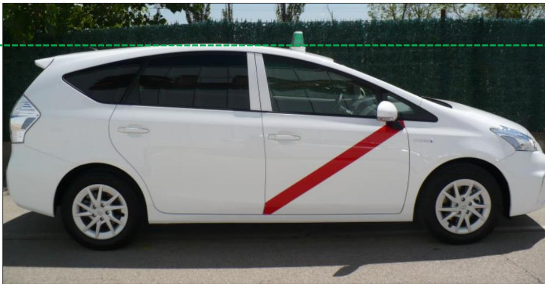
**Instalar la capilla lo suficientemente elevada como para que la curvatura del techo no tape la tarifa.**
