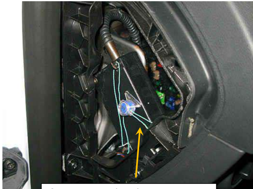
Caja de conexión eléctrica precintada
