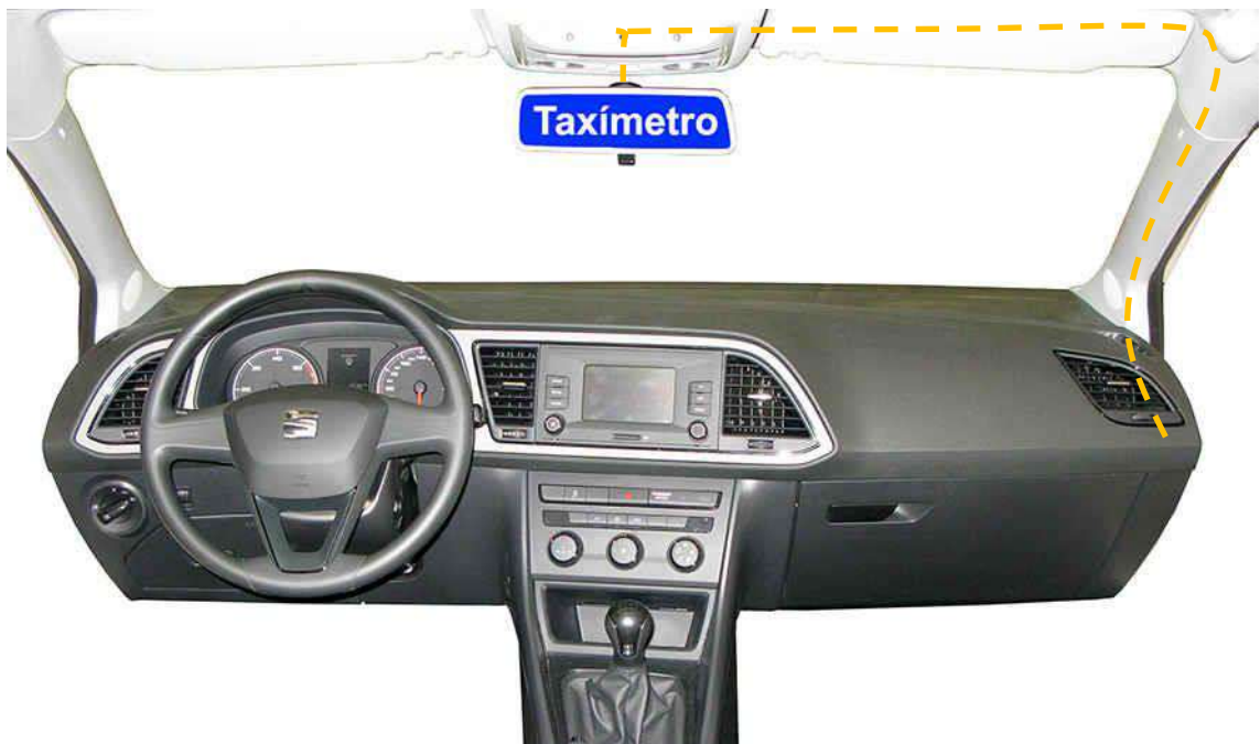
Recorrido de la manguera de señal de velocidad
