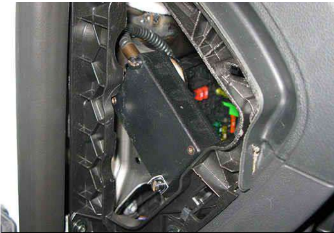
Caja de conexión eléctrica en el alojamiento de la cubierta izquierda
