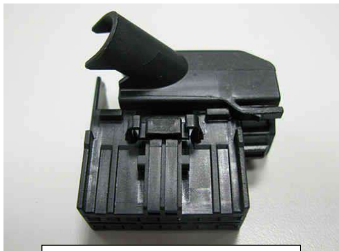
Conector 4A0.972.883.C para la conexión a la unidad de control
