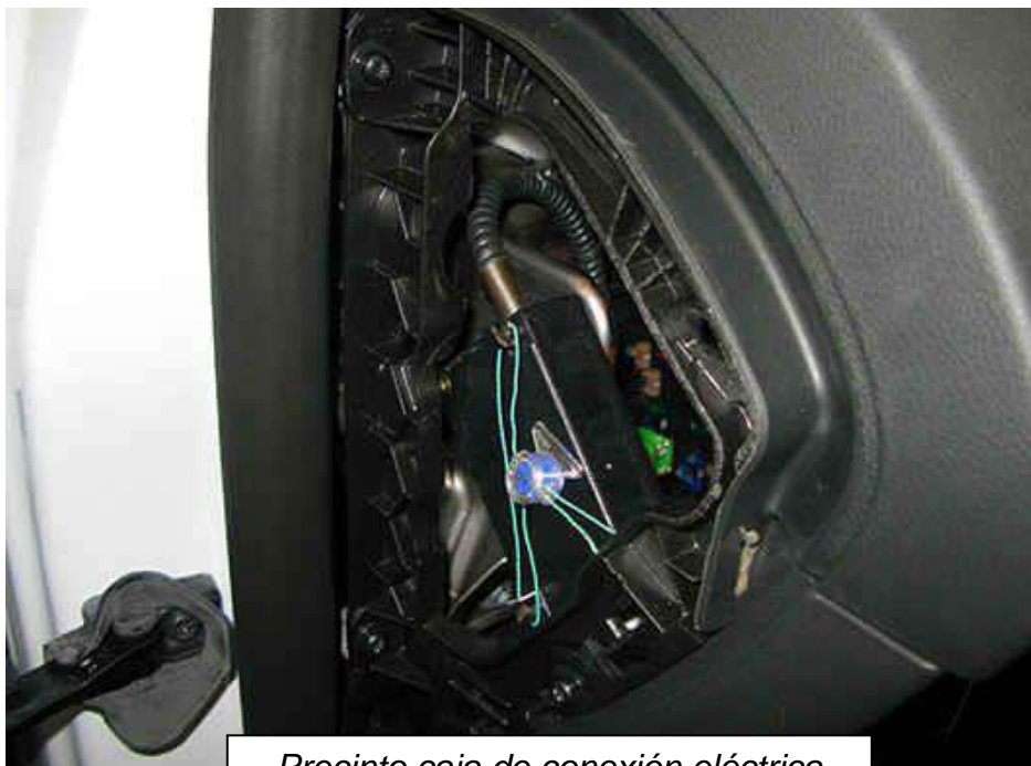
Precinto caja de conexión eléctrica (alojamiento cubierta lateral izquierda)
