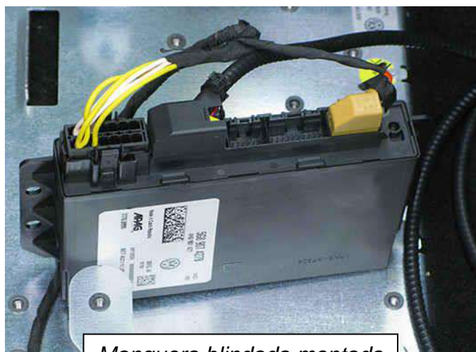
Manguera blindada montada en la unidad de control
