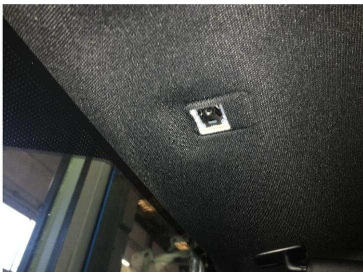
Llevamos el conjunto de cables desde el pilar A, a la zona central donde está localizado el retrovisor, desmontando la carcasa del mismo para la salida de los cables por esa zona.
