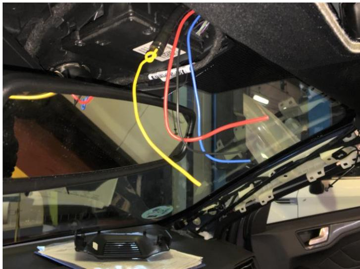
En este punto la conexión del taxímetro con las tomas proporcionadas en la preinstalación del fabricante no ha de plantear ningún problema.
