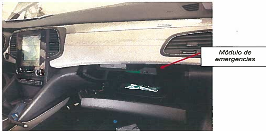
Fig. 7.1. Vista del emplazamiento del módulo de emergencias.
