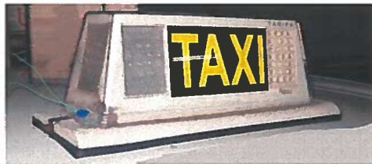
Fig. 6.3. Vista del módulo y su precinto
