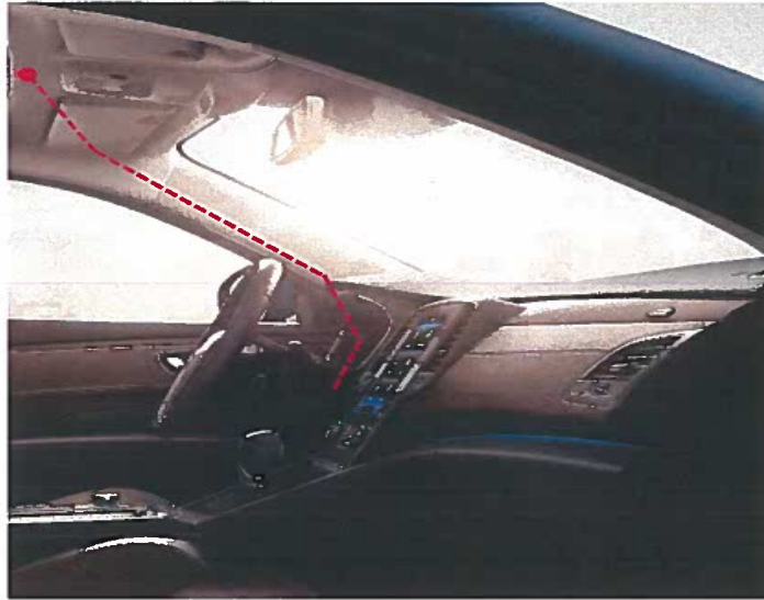
Fig. 6.2. Vista recorrido del cableado entre el módulo y la caja adaptadora de señal
