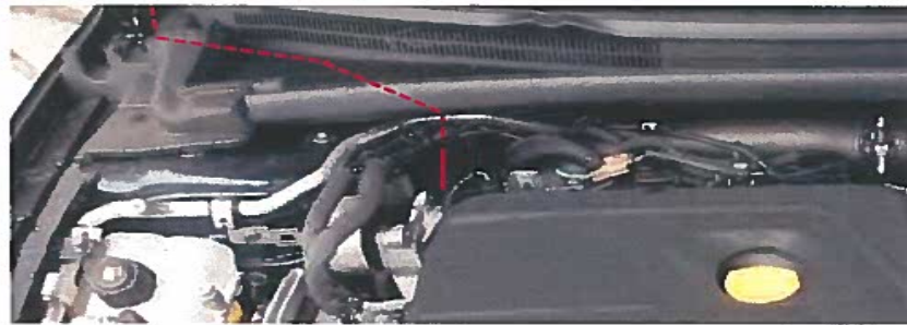
Fig. 6.6. Recorrido del cable por debajo del vierte aguas para paso al habitáculo
