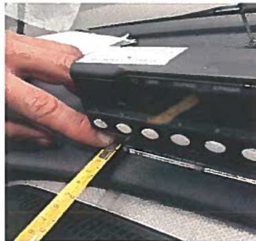
Fig. 5.2. Separación taxímetro a borde salpicadero.
