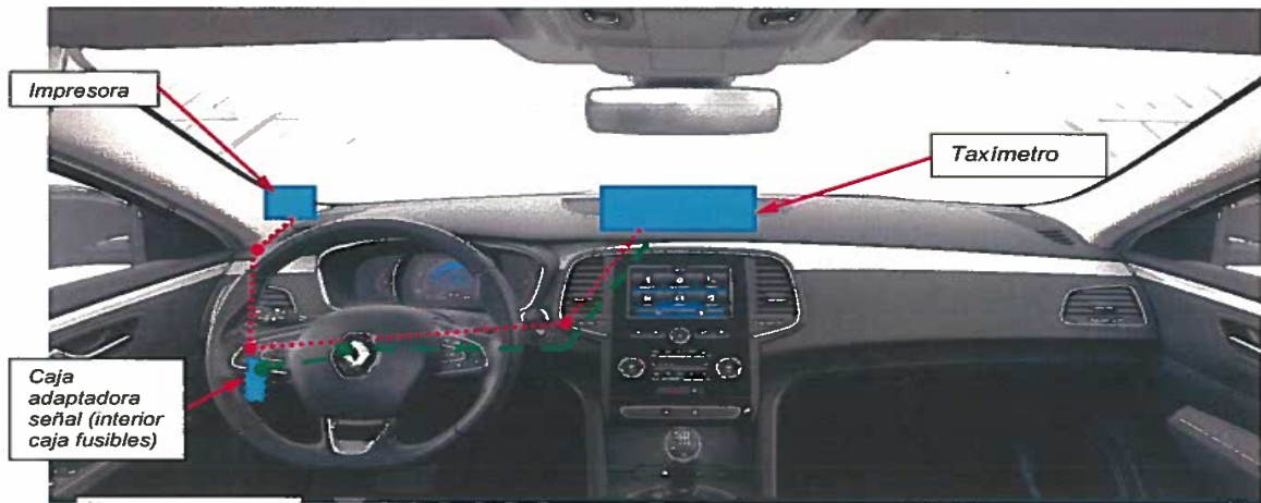
Fig. 4.1. Esquema orientativo del recorrido de las conexiones para taxímetros sobre salpicadero.
