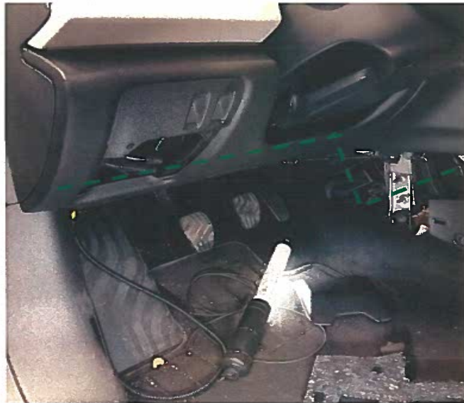
Fig. 2.5 y 2.6. Recorrido de la manguera blindada por debajo del guarnecido del salpicadero hasta el compartimento de la caja de fusibles
