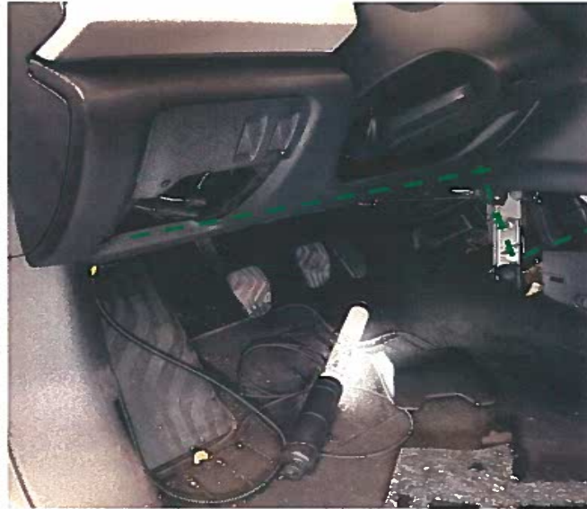
Fig. 7.2 y 7.3. Recorrido de la manguera blindada del módulo hasta la caja de conexiones por debajo del guarnecido del salpicadero
