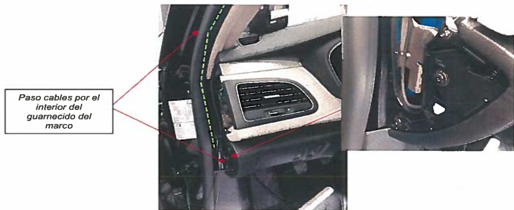
Fig. 4.5. Paso de cables del taxímetro de espejo a la caja adaptadora.
