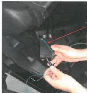
Precintado caja adaptadora de señal
