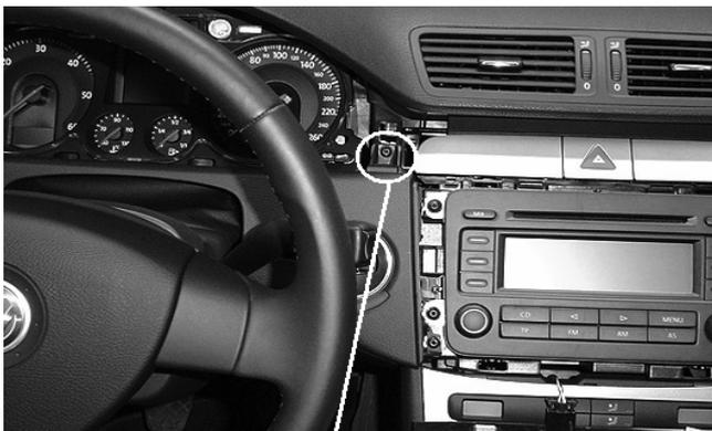
Tornillo de fijación para sustituir
