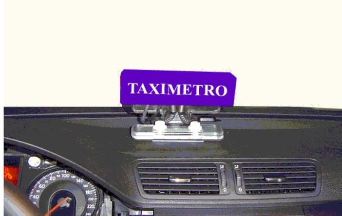
Se conecta el dispositivo impresor y se instala en la parte superior izquierda del salpicadero, haciendo pasar el cable por detrás del cuadro y subiéndolo por la parte externa del embellecedor izquierda del montante A. Es recomendable retirar el embellecedor del montante A para poder realizar dicha operaci3n.
