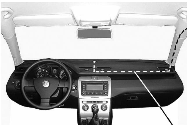
Recorrido del cable del módulo repetidor de tarifas
