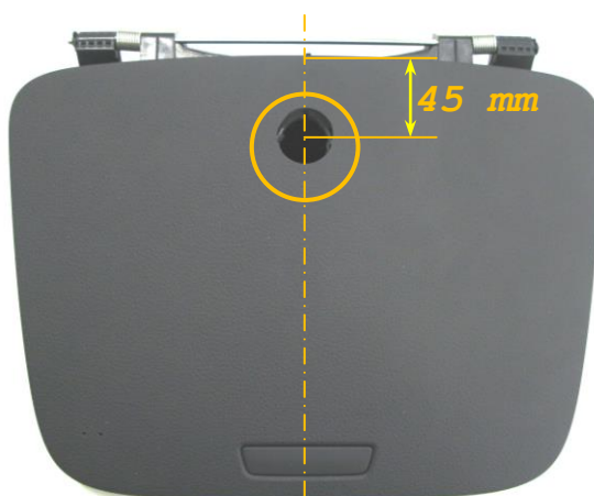
Agujero \varnothing 30 mm en la tapa guantera central
