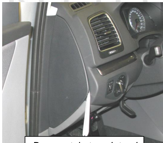
Desmontaje tapa lateral
