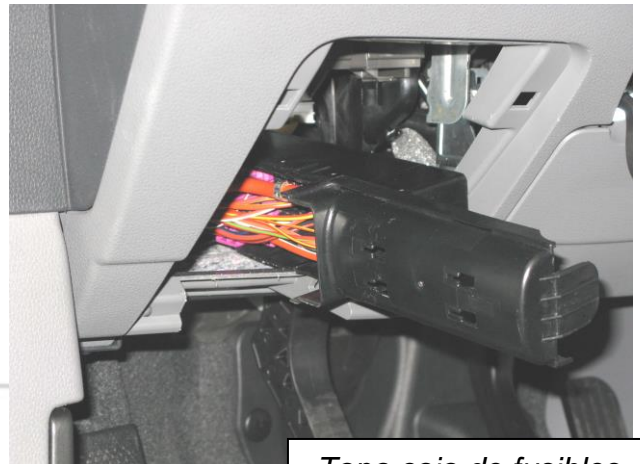
Tapa caja de fusibles
