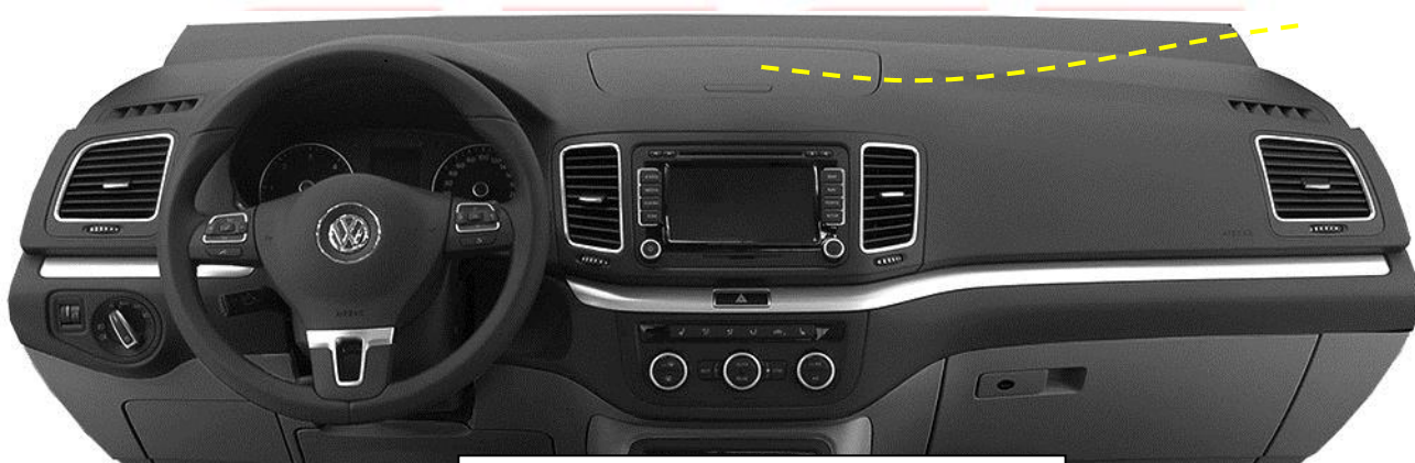
Trazado del cable módulo tarifario
