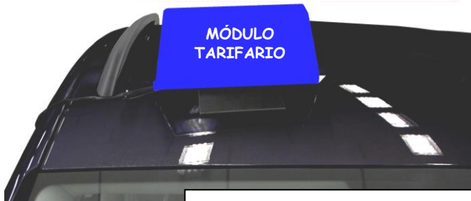
Emplazamiento y paso del cable del módulo tarifario
