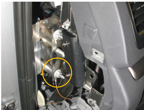
Cable de masa y caja de conexión eléctrica
