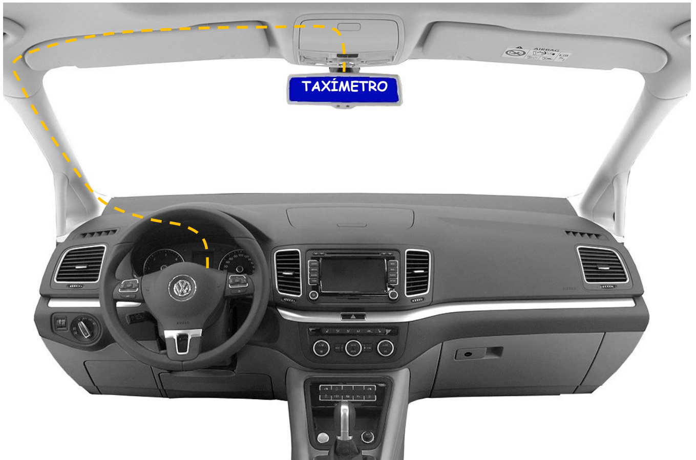
Recorrido de la manguera del taxímetro hasta el cuadro de instrumentos
