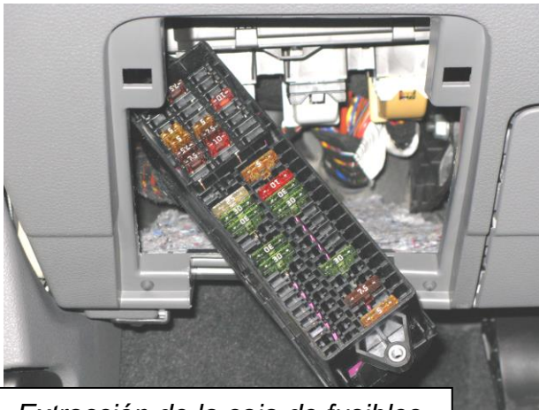
Extracción de la caja de fusibles
