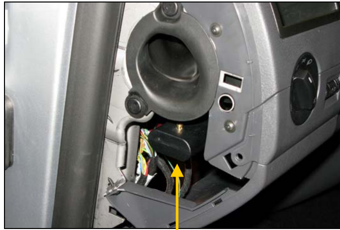
Caja de conexión eléctrica
