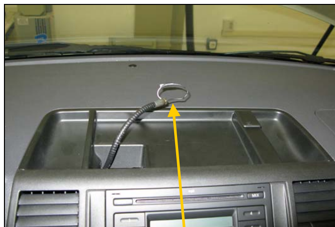
Manguera blindada con los cables verde y negro unidos
