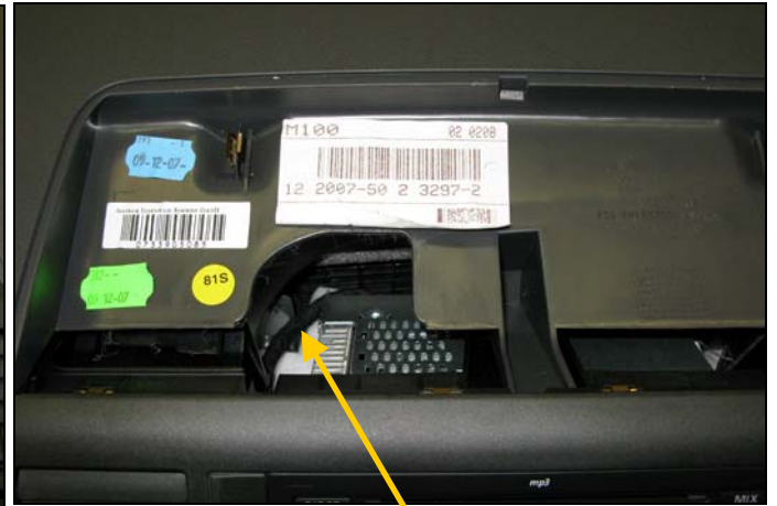
Apertura para pasar la manguera blindada
