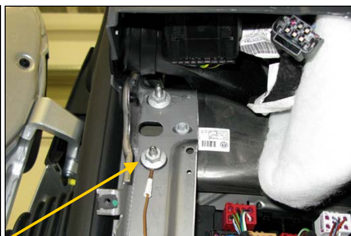
Punto de conexión para la masa en la parte inferior del montante A, lado conductor
