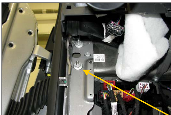
Punto de conexión para la masa en la parte inferior del montante A, lado conductor
