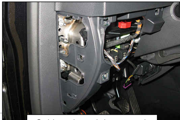
Cubierta lateral desmontada
