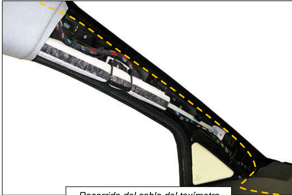
Recorrido del cable del taxímetro
