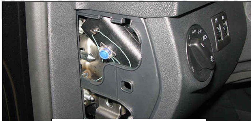
Precinto caja de conexión eléctrica
