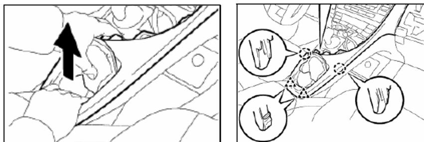
Tire de nuevo del panel central de instrumentos en la dirección de la flecha para soltar las 5 grapas y saque completamente el panel.
