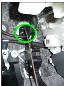
2) La caja de señales donde irá conectada la manguera blindada proveniente del cuadro de instrumentos irá instalada sobre la tapa de la caja de fusibles del motor, fijada mediante tornillos y precintada.
