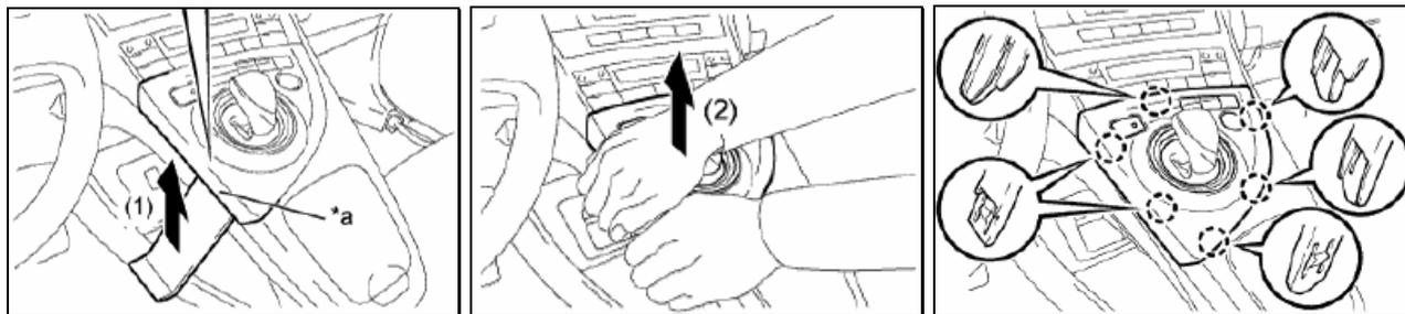
2) **Desmante el panel central de instrumentos:** Tire del panel central de instrumentos en la dirección de la flecha para soltar las 2 grapas y los 2 clips.
