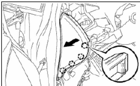
13) **Desmonte el canalizador de aire superior derecho:** Con un desmontador de molduras levante suavemente el canalizador como figura en la imagen. Después tire en la dirección de la flecha para soltar las tres grapas y saque la pieza.
