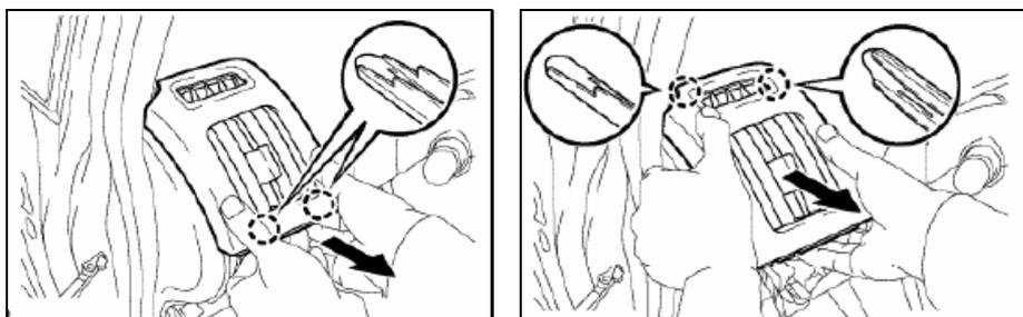
10) **Desmonte el embellecedor del panel de instrumentos, lado derecho del volante:** Suelte las 4 grapas, desenchufe el conector y saque el embellecedor del panel de instrumentos.
