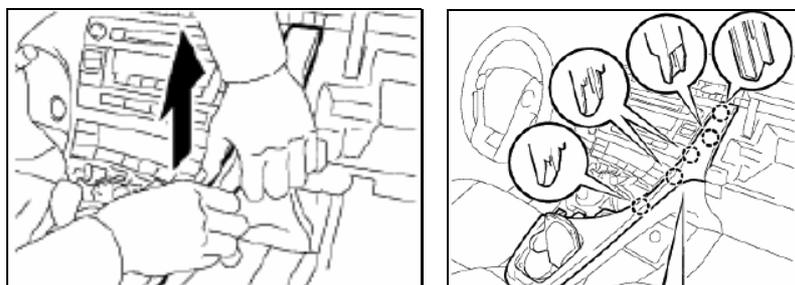
3) **Desmante el posavasos:** Mediante los 4 tornillos, saque el posavasos del panel central de instrumentos.
