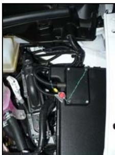
3) La alimentación eléctrica se tomará de la propia caja de fusibles, en concreto de un borne que hay en su interior al cual se accede levantando una tapa de plástico negra. En esta alimentación se montará un portafusible aéreo con fusible de protección. La masa se cogerá con un tornillo en la chapa que hay en la parte inferior de la caja de fusibles.
