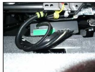
7) La impresora, en caso de no estar integrada en el propio taxímetro, irá instalada en el lado izquierdo del salpicadero. Su fijación será con velcro de alta resistencia, y el cable se llevará a través del guarnecido de esquina del pilar A izquierdo.
