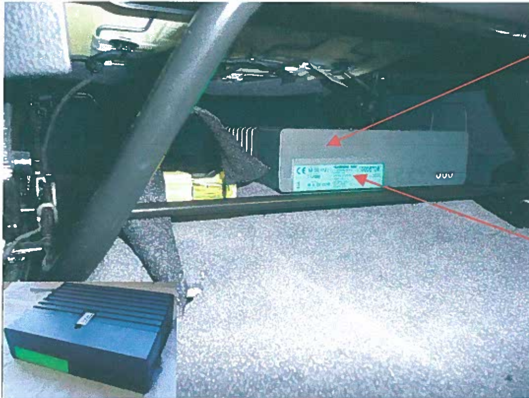
Fig. 2.4. Vistas de la caja adaptadora de señal con módulo de emergencias integrado.
