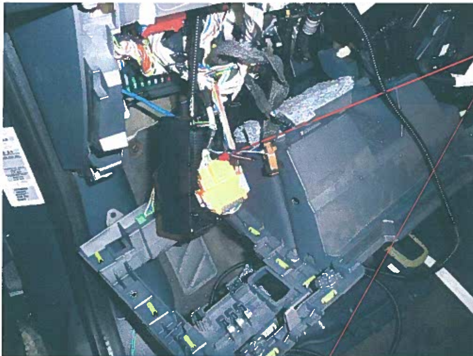
Fig. 2.1. Vista del conector IC01 extraído. La señal se obtendrá de la parte trasera.
