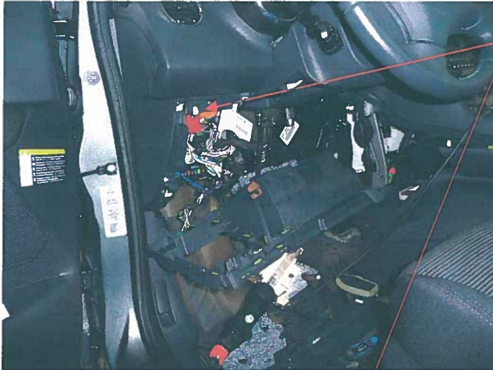
Fig. 1.3. Vista detalle de la caja de fusibles y conector IC01.
