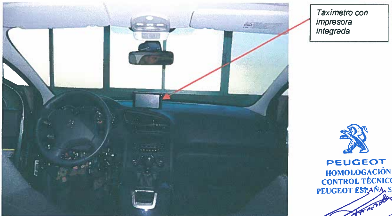
Fig. 5.3. Vistas de la disposición del taxímetro con impresora integrada.
