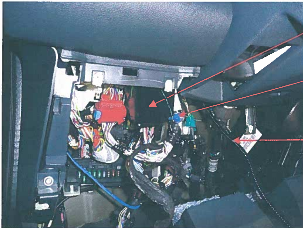
Fig. 3.4. Inserción de la caja precintada en el interior del compartimento de conexiones
