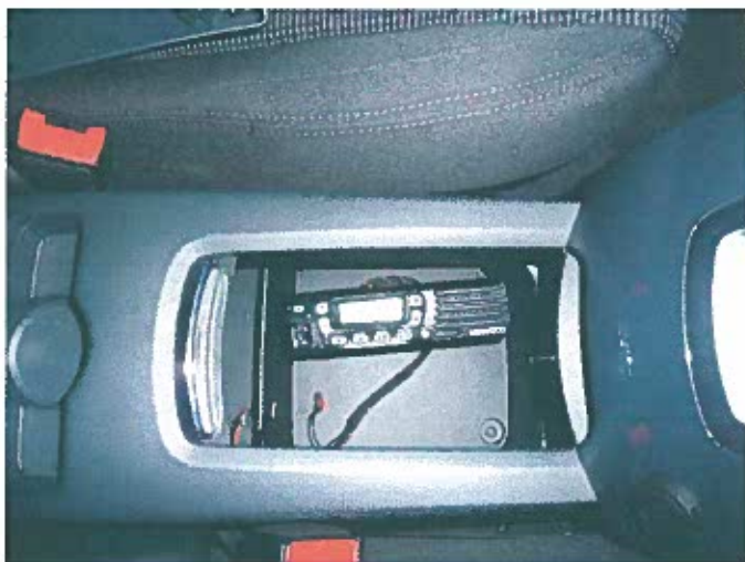
Fig. 11.2.2 Vista superior del emplazamiento de la emisora de radio.
