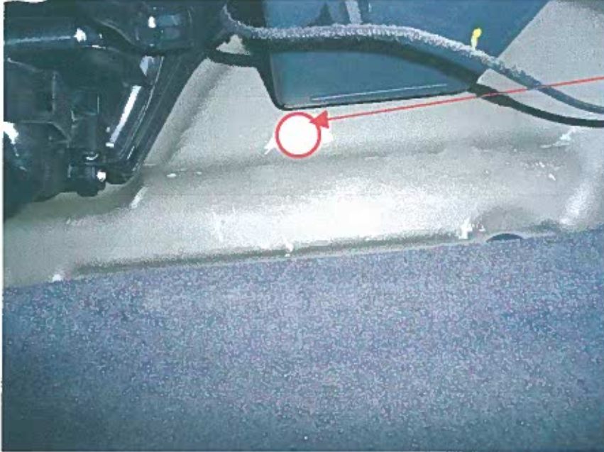
Fig. 2.2. Vista donde se muestra dónde se debe realizar el orificio desde el interior del habitáculo pasajero delantero.
