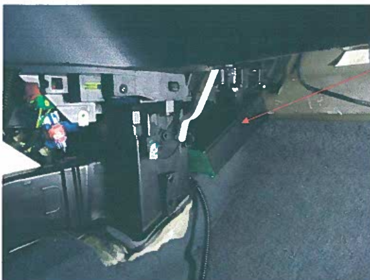
Fig. 11.1.1. Vista del emplazamiento del módulo de emergencias en la parte inferior delantera de la consola central.
