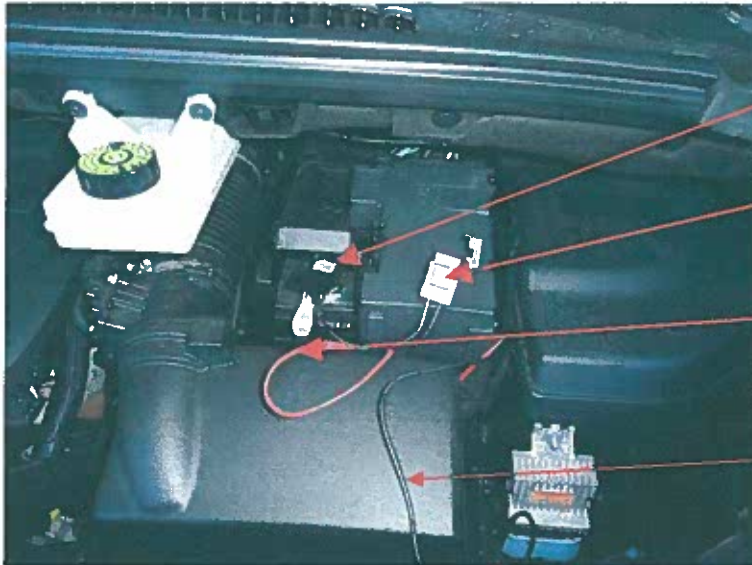
Fig. 4.3. Fotografía del cable de alimentación conectado a la batería del vehículo
