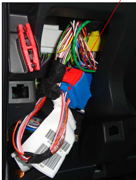
Fig. 2.2. Vista del conector IC01B extraído. La señal se obtendrá de la parte trasera. PIN16.
