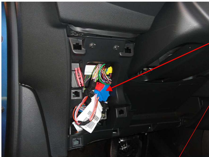
Fig. 2.1. Vista del conector IC01B extraído. La señal se obtendrá de la parte trasera.
