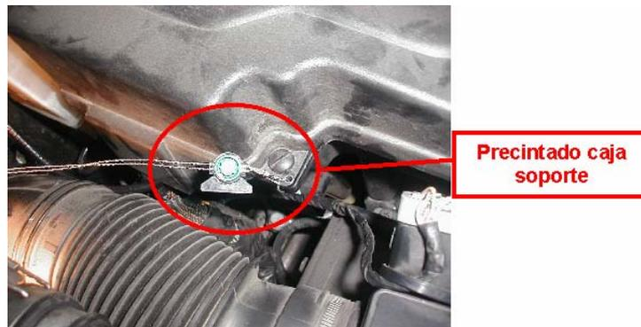
La caja convertora (si procede) se situará en el frente del habitáculo motor, al lado del depósito y sujeta por una brida.
